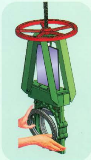
3.- Instalar los nuevos asientos con la cuchilla En posición abierta.
