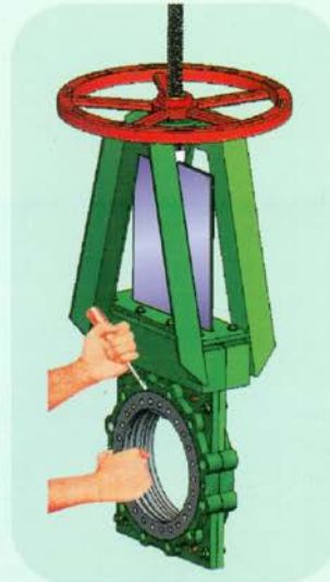
2.- Retirar los asientos desgastados y limpiar de partículas metálicas, tierra etc.
